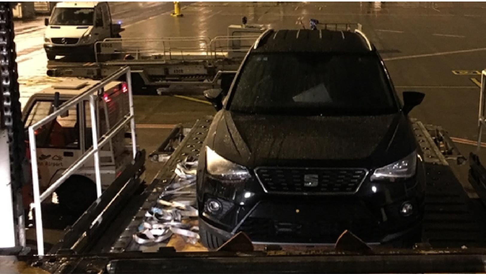
Bildunterschrift: Der Seat Arona, der aufgrund der Fahrzeugdimensionen nicht palettiert im Lowerdeck eines Airbus A330 ladbar ist, wurde auf dem Eurowings-Flug im Roll-In-Verfahren ein- und ausgeladen.
